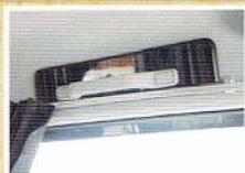
セカンドシートを倒して、フルフラットにベッドを展開できます(1,800mm×1,000mm)。アシストグリップ部分などの細かな部分にまで高品質な装いにこだわり、カーテンはブリーツ加工を施しました。小さな空間も無駄にしないよう、天井部分にもキャビネットを設置。車両標準のドア開閉連動の室内照明も、オプションで常夜灯付きのLEDタイプに変更できます。
